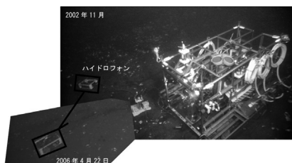
写真-2 泥流発生前と発生後のカメラ観察映像によるハイドロフォン(水中マイクロフォン)の位置の変化。
