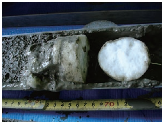
図 16 海鷹海脚中部のマウンドからピストンコアラで回収された塊状のメタンハイドレート (口絵 1 参照).
