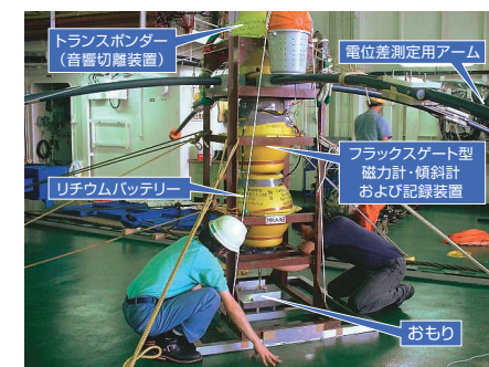
海底電位差磁力計（OBEM）の構成
