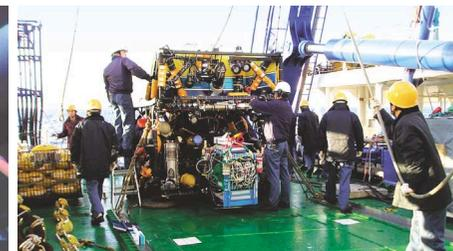
**船上での海底電位差磁力計の設置準備作業**
